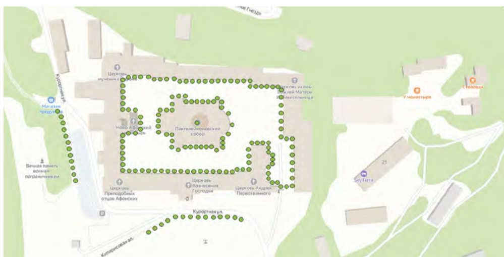
Места установки сейсмодатчиков
