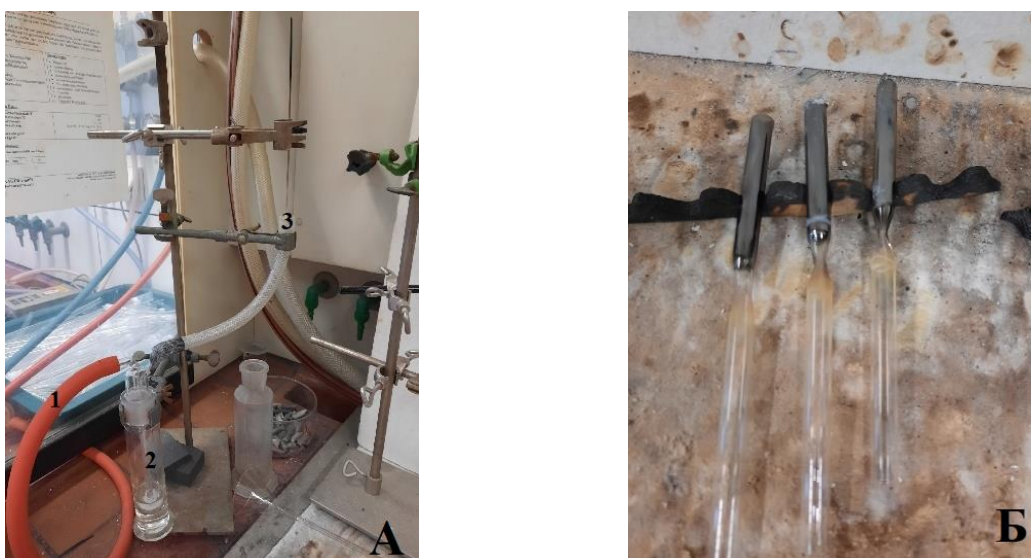
Рисунок 2.5 – А. Конструкция для нанесения графитового слоя на стенки ампул, где 1. Инертный газ носитель Ar; 2. Барботер наполненные C_2H_2 ; 3. Игла для выхода газов; Б. Ампулы с нанесенным графитовым слоем
