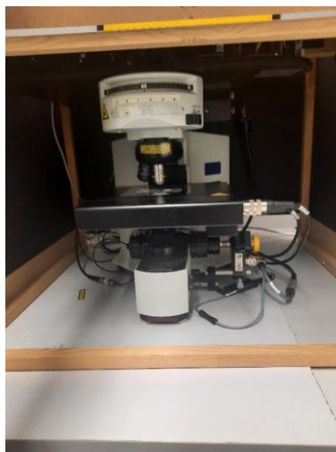
Рисунок 2.9 – Рамановский спектрометр XploRa фирмы Horiba
