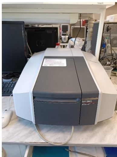
Рисунок 2.14 – УФ спектрофотометр UV-2600 (Shimadzu)
