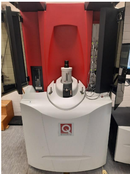
Рисунок 2.10 – СКВИД-магнитометр MPMS3 (Quantum design)
