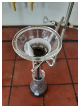
Рисунок 2.8 – Промывка образца от остатков флюса
