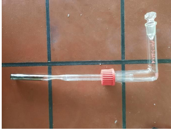
Рисунок 2.6 – Ампула с быстросъемным уплотнением
