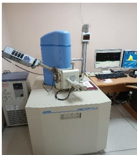
Рисунок 2.13 – РЭМ JEOL 6510 LV (JEOL)
