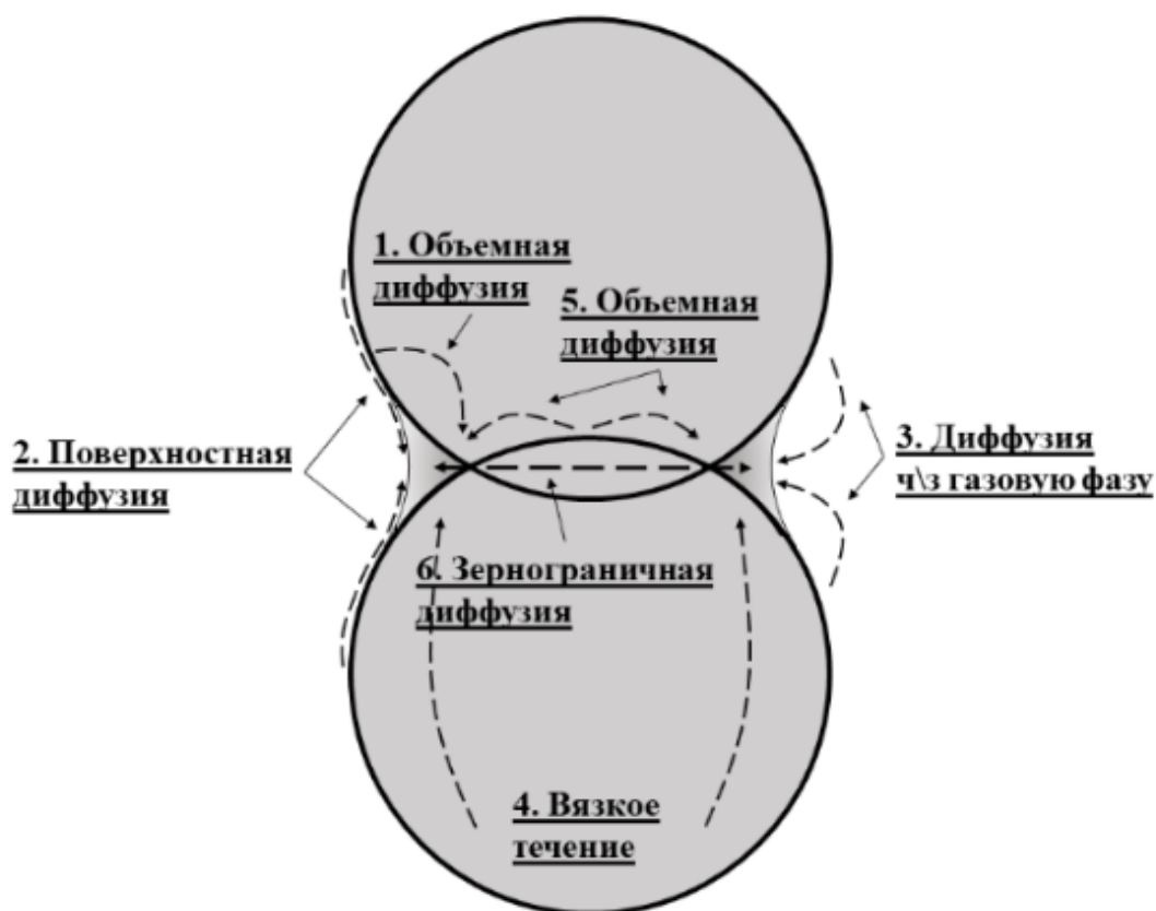
Рисунок 3. Основные механизмы спекания.
